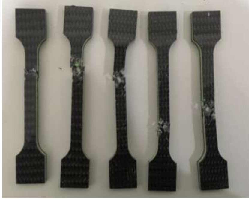
Şekil 3.15 : 45° açı ile kesilen numuneler.
