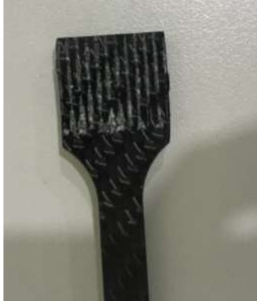
Şekil 3.17 : 0° numunelerde gözlemlenen kayma izleri.
