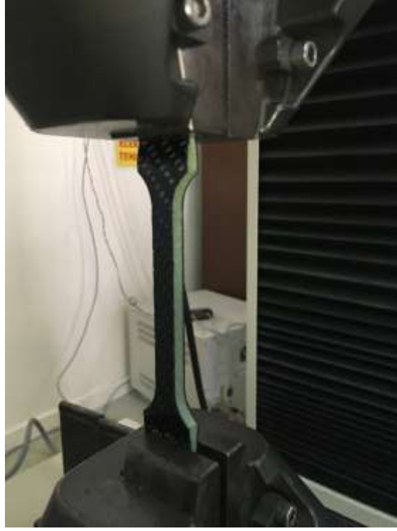
Şekil 3.13 : Numunenin çenelere bağlanması.
